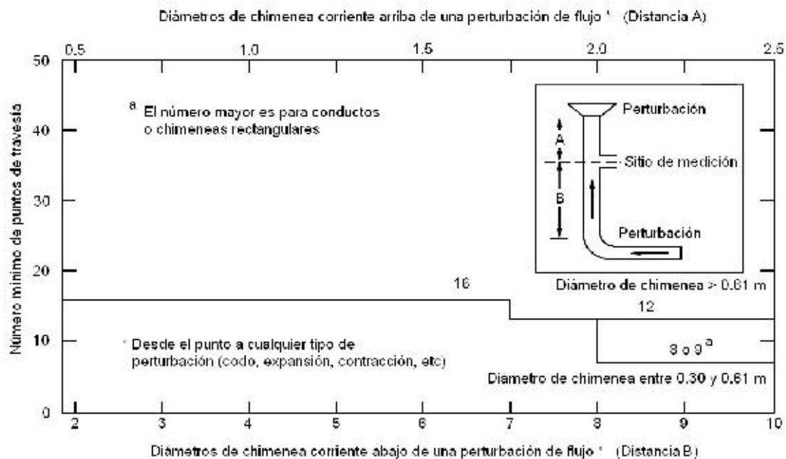
Para usar la figura 2 se debe calcular la distancia (número de diámetros de conducto o chimenea) antes y después de la perturbación más cercana al punto de medición. Para eso, se debe determinar la distancia desde el lugar de medición hasta las perturbaciones corriente arriba y corriente abajo más cercanas, y dividir cada distancia por el diámetro del conducto o chimenea para determinar la distancia en términos de número de diámetros.
